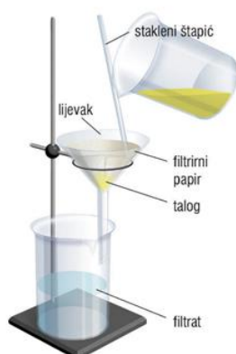
Slika 5.8. Aparatura za filtriranje.
