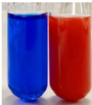
Slika 6.3. Dokaz glukoze Fehlingovim reagensom.
