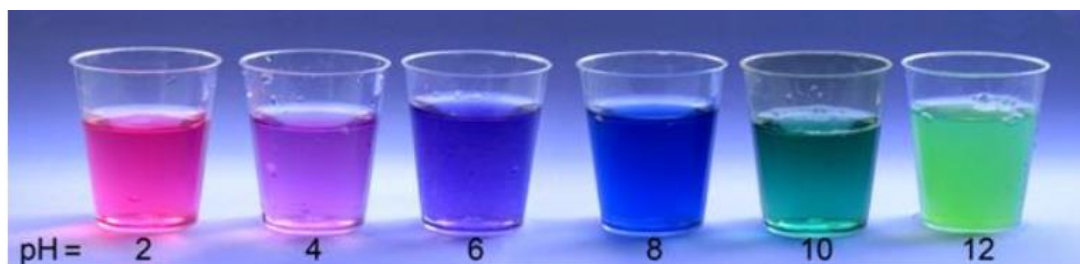
Slika 4.18. Promjena boje otopine soka crvenog kupusa ovisno o pH otopine.
