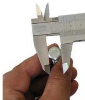
Slika 3.8. Pravilno zahvaćanje predmeta pomičnom mjerkom.
