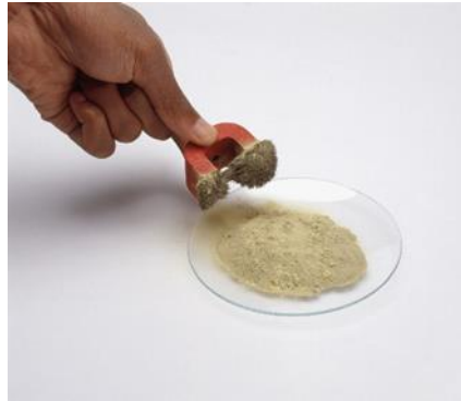
Slika 5.10. Odjeljivanje sastojaka smjese magnetom.
