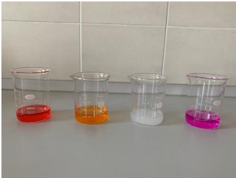
Slika 4.17. Karakteristične boje metiloranža i fenolftaleina i u kiselim i lužnatim otopinama.
