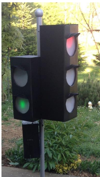
Slika 12. Model semafora baziran na Arduino platformi.
